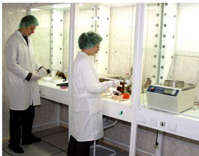
**Рис. 17.** «Чистая комната» для реализации химико-технологических этапов LIGA-технологии (подготовка подложек, нанесение и обработка резистов, микрогальванопластика).
