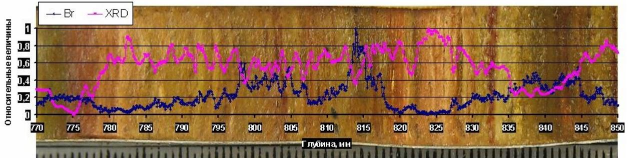
Рис.4. Вариации содержаний брома и рентгеновской плотности вдоль ядра осадков оз.Телмен.
