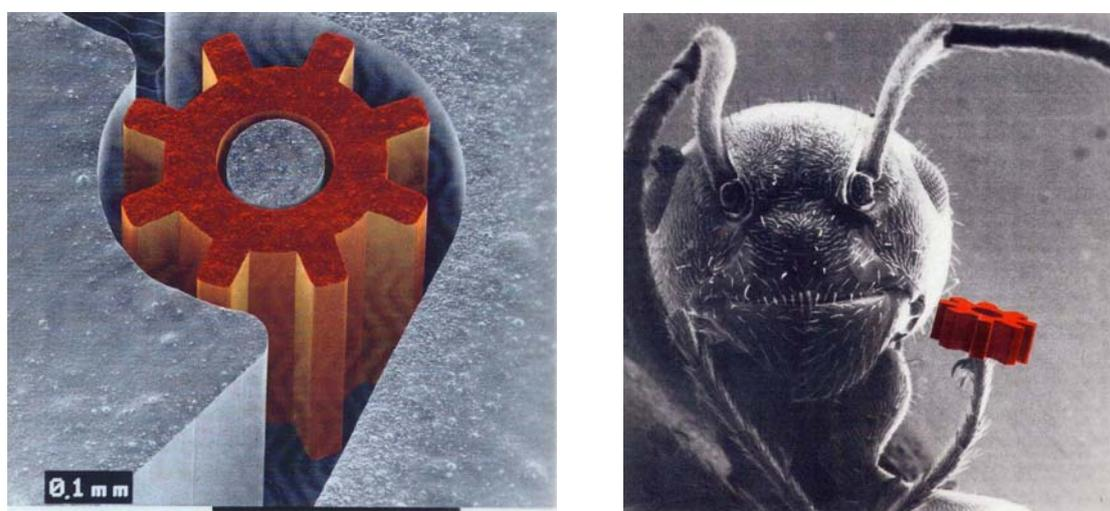
**Рис. 24.** Образец микротурбины, изготовленной с помощью LIGA-технологии. Для масштаба показан муравей.
